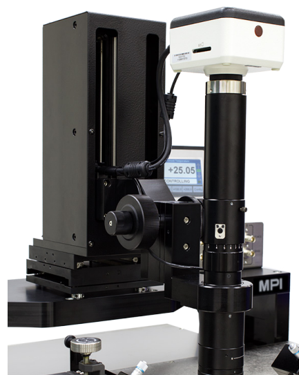
図9: MegaZoom™ MZ12単眼鏡筒 + HDMIカメラ
