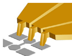
図14: TITAN™ プローブ・チップ構造
