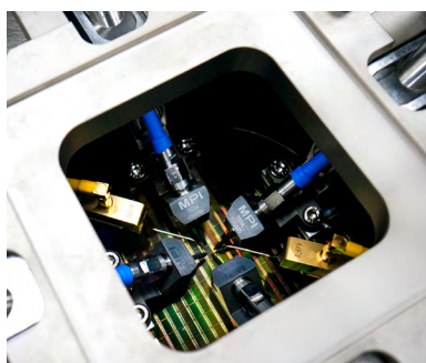
MPIケルビン・プローブを使つての構成例
