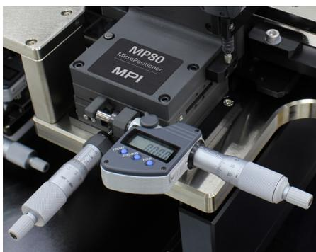
オプションのMP80-DXポジションはデジタル・マイクロメーターを装備しており、マルチラインTRL校正を簡単に実現します。プローブの初期調整後(例: 校正基板のTHRUを使って)デジタル・マイクロメーターの値を0にセットすれば、RFプローブの間隔は簡単にΔL 値(1 μm精度)に再調整が可能です。
