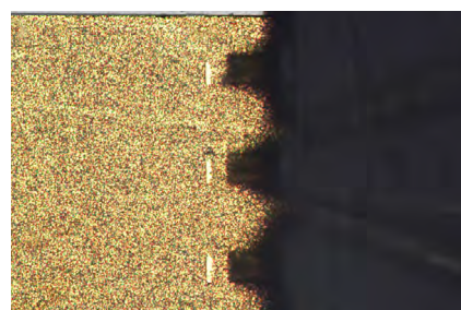
図2. プラナリティが取れた時のプローブマーク
