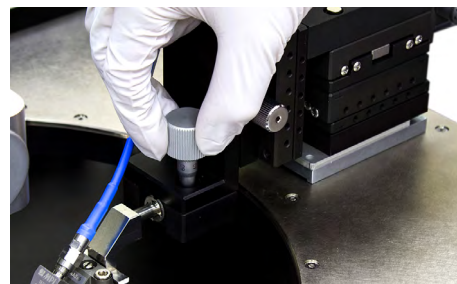
図4. TITAN™ プローブのプラナリティ調整
