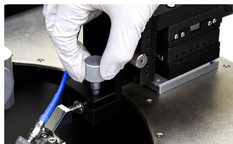
図6. TITAN™プローブのプラナリティ調整
