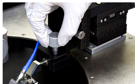
図4.TITAN™プローブのプラナリティ調整
