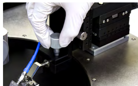
図4.TITAN™プローブのプラナリティ調整
