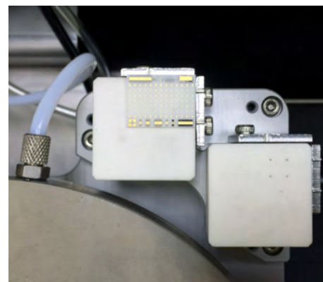
セラミック製補助チャック上のAC2-2校正基板 (TS150-THZマニュアル・プローバー)
