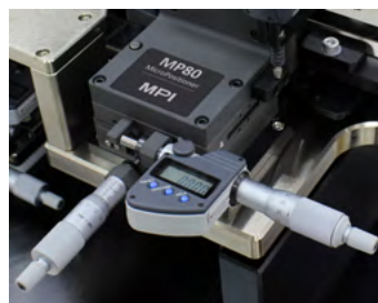
X軸デジタル・マイクロメータ付MP80-DX ® ポジション。
