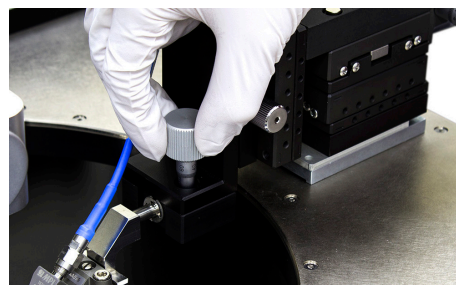
図4.TITAN™プローブのプラナリティ調整
